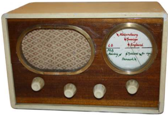
Den hjemmebyggede 3½-rørs modtager med den specielle skala
